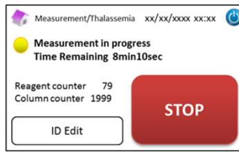
**Remarque :** Appuyer sur « STOP » annule la mesure. L'Analyseur RC-W prendra environ 8 minutes pour amorcer le système.
