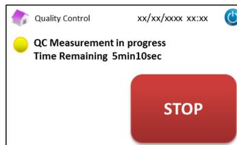
**Remarque :** Appuyer sur "STOP" annule la mesure. L'Analyseur RC-W prendra environ 8 minutes pour amorcer le système.
